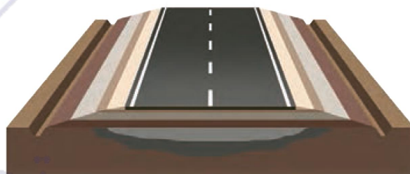
الف) لایه های مختلف راه بر روی بستر طبیعی
